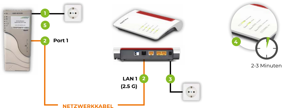
Netzabschlussgerät (ONT, z. B. GENEXIS-Box)
